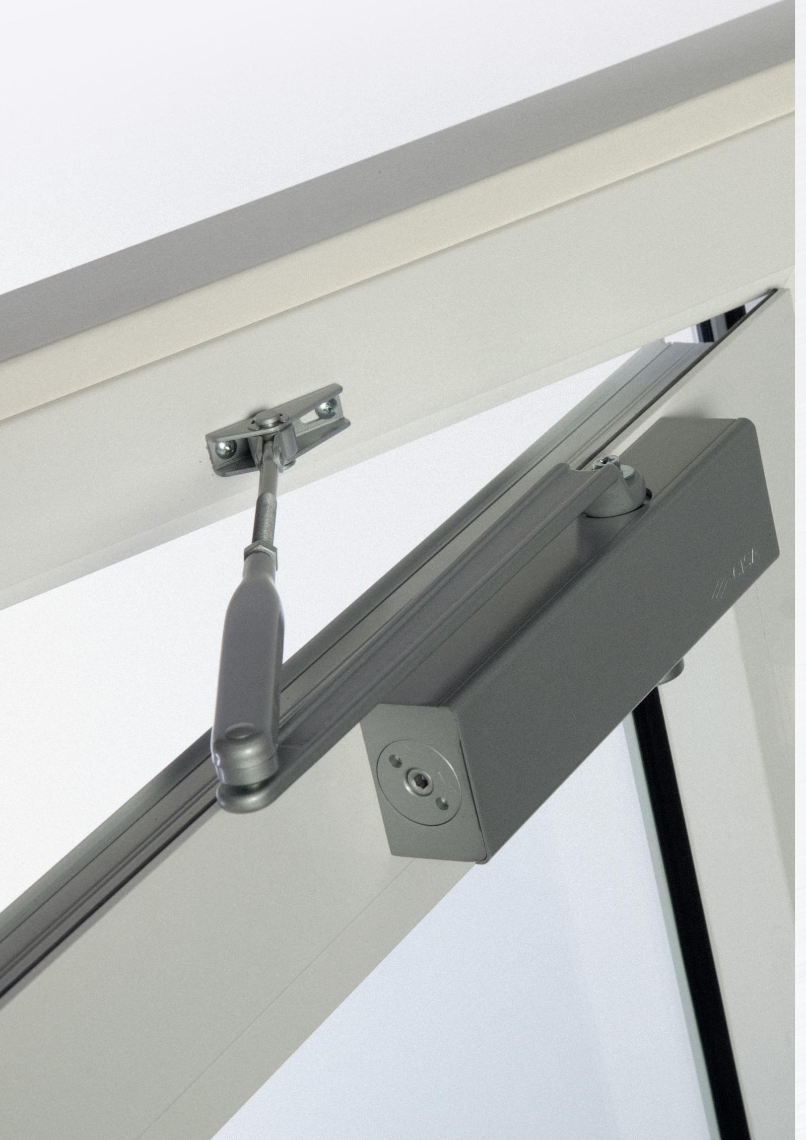
Variaciones de la fuerza y dimensiones máximas de la puerta. El cuerpo permanece en posición fija, variando la posición de la bisagra soporte del brazo y actuando sobre la válvula lateral regulamos la fuerza de cierre de la puerta.
